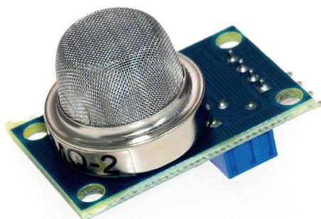
Датчик углеводородных газов MQ-2
