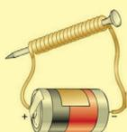
Если на металлический стержень намотать медную проволоку и подключить ее к источнику питания, то у стержня появятся магнитные свойства, которые исчезнут при отключении от источника питания.
