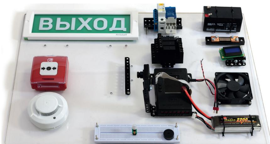
Собранный стенд «Пожарная и охранный сигнализация»
