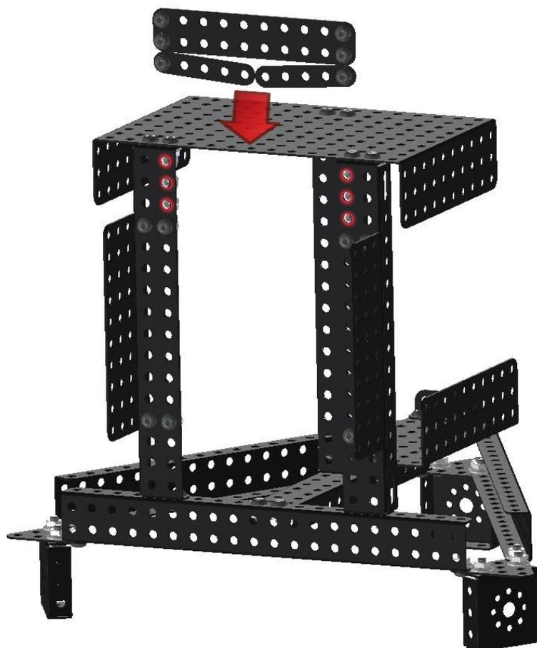
Возьмите балку 1x2x1x20 и закрепите ее на пластинах 1x5 и балке 1x2x1x20 винтами и гайками М4.
