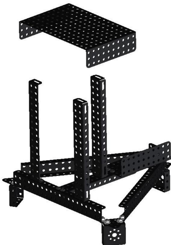
Соедините основание на шесть винтов и гаек М4 по примеру.
