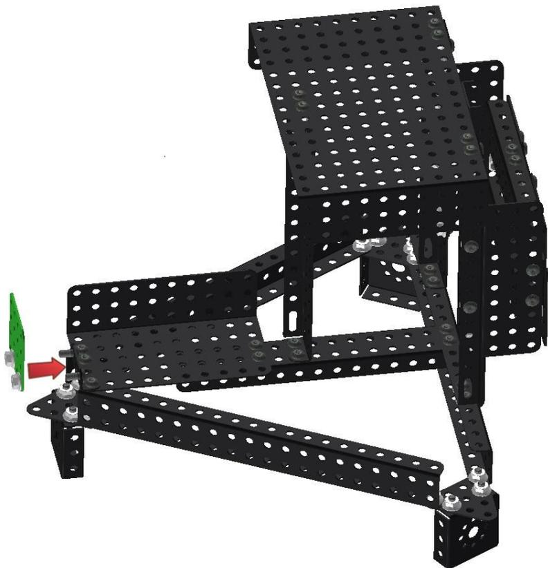
Возьмите уголок 1x1x5 и закрепите его двумя винтами и гайками.
