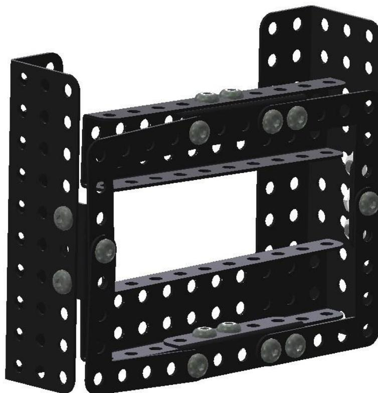
Соедините готовую конструкцию с заготовкой модели штабелера с помощью четырех винтов и гаек М4 по примеру.
