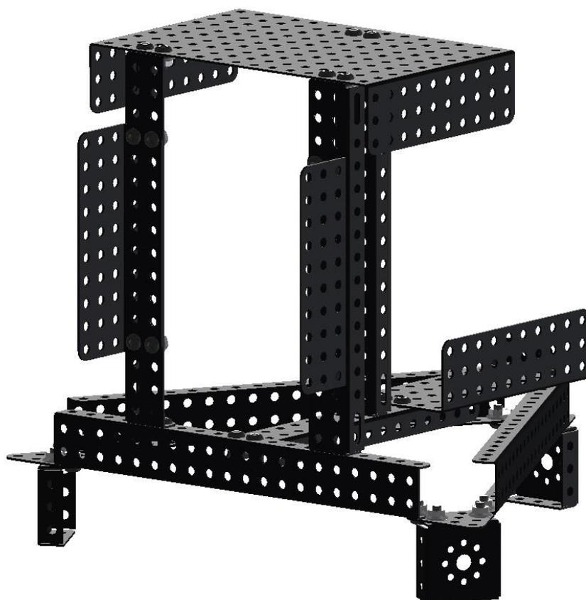
Возьмите одну пластину 2x10 и две пластины 1x5, закрепите их на швеллерах винтами и гайками М4.
