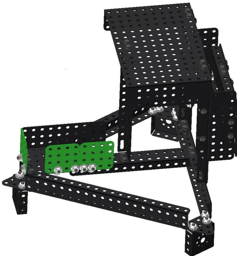
Возьмите две пластины 1x10 и закрепите их на углу 5x3 двумя гайками и винтами М4.
