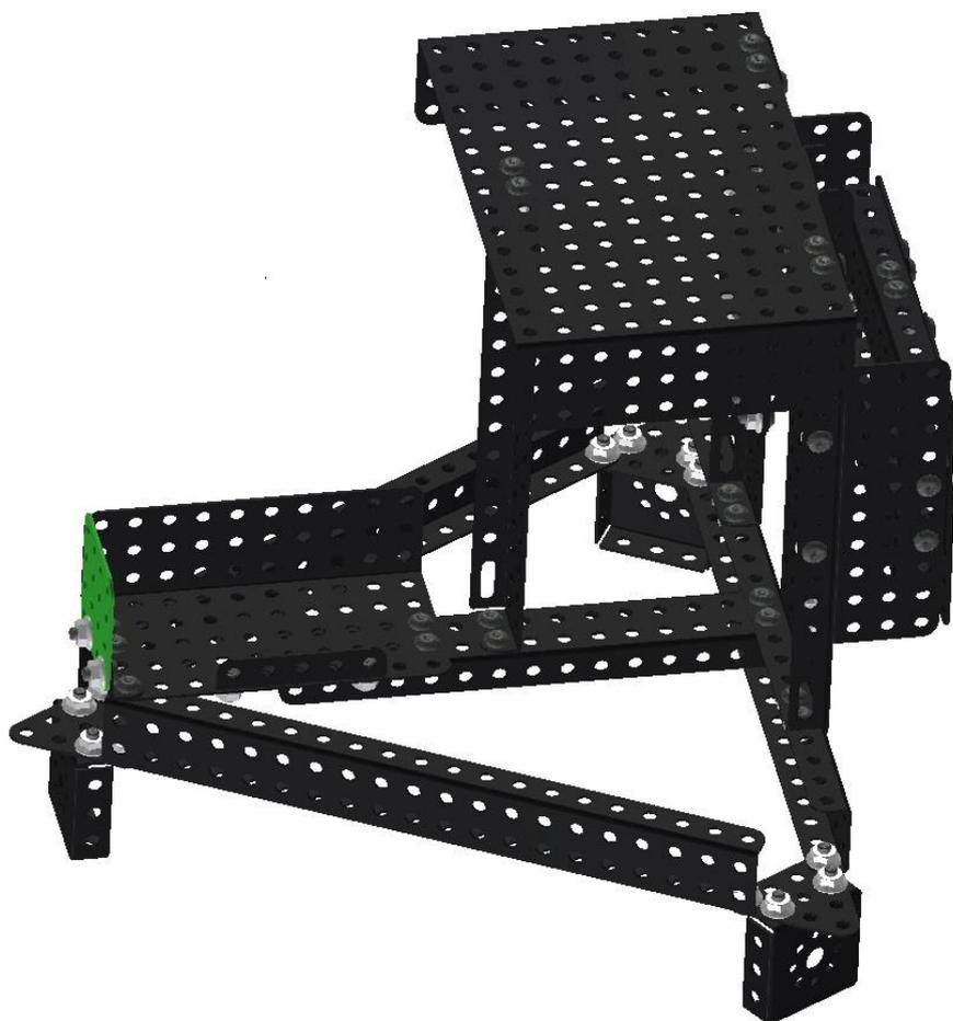
Возьмите две пластины 4x4 и закрепите их четырьмя гайками и винтами на уголок 1x1x5.
