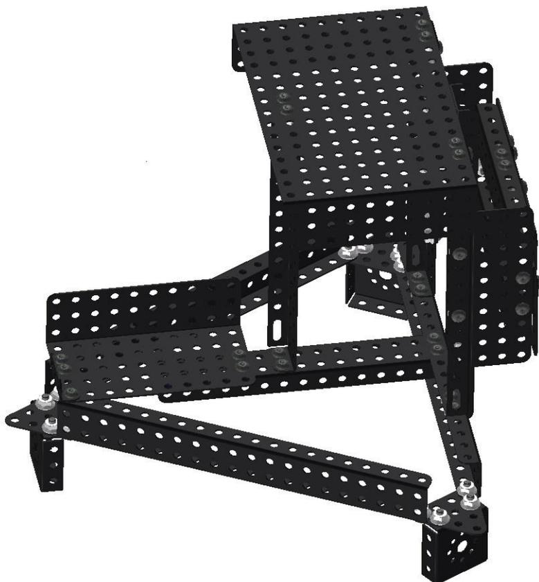
Возьмите пластину 4x4 и соедините ее двумя винтами и двумя гайками М4.
