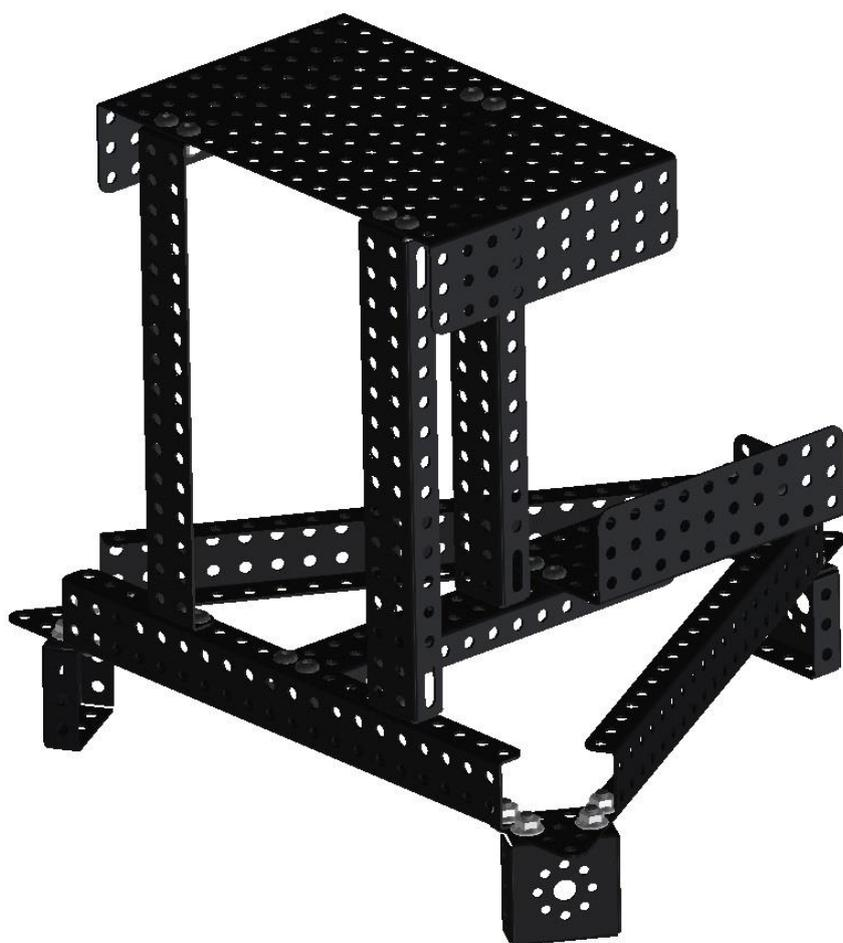
Возьмите два угла 5x3 и закрепите их четырьмя гайками и винтами М4 по примеру.
