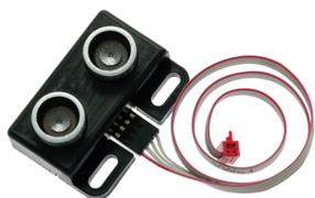
**2** x Датчик расстояния УЗ с проводом для подключения к контроллеру. Измеряемая дистанция — от 10 до 256 см, точность измерения — 1 см
